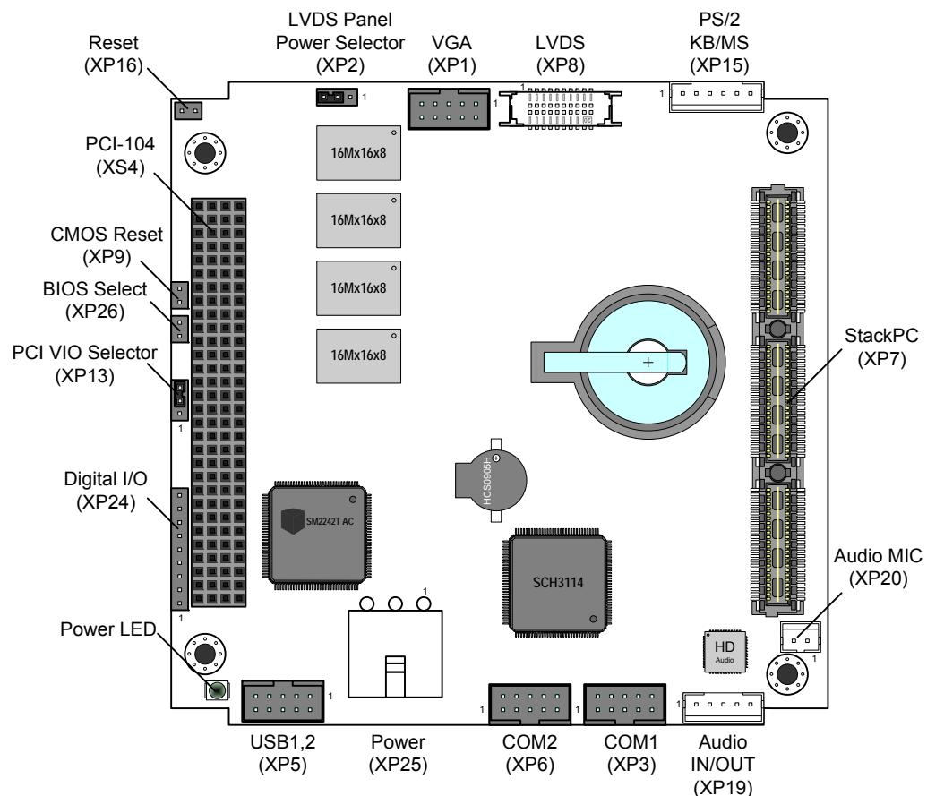
Рис. 3-3: Расположение разъёмов и основных компонентов на стороне BOTTOM
